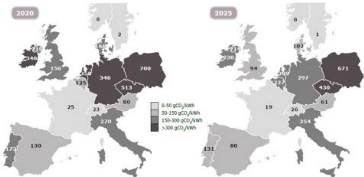
Figure 1.8. Évolutions attendues de l'intensité carbone de la production d'électricité dans l'UE (en gCO 2 /kWh) 5
